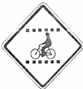
Figura 41 – Placa A-45: Passagem de ciclista à frente (dirigida aos motoristas)
