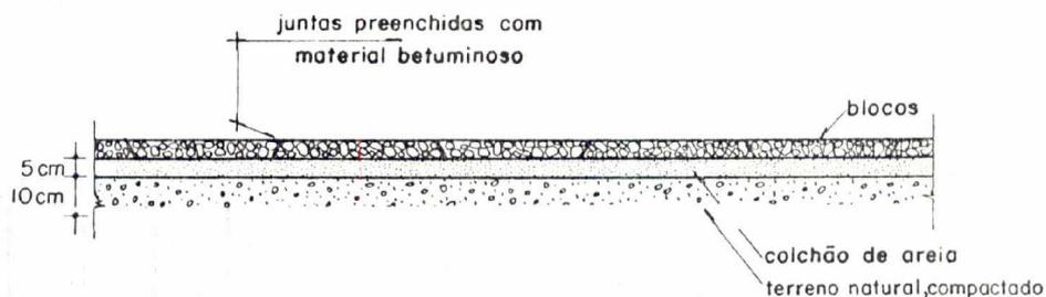
Figura 29 — Blocos pré-moldados de concreto
